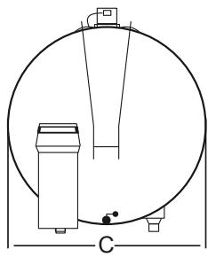
Ab Modell P 8000 sind die Behälter mit Sprühköpfen (mit abnehmbarer Reinigungsleitung) ausgestattet.
