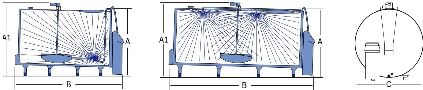
Pour les modèles P-8000 et supérieurs, les cuves sont équipées d'un nettoyage par boules de pulvérisation (avec tuyau de nettoyage amovible).
