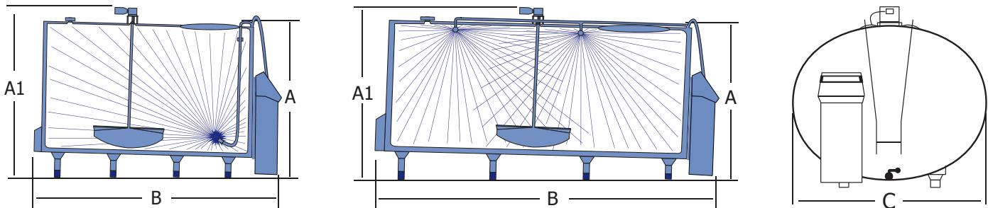
Pour les modèles O-2000 et supérieurs, les cuves sont équipées d'un nettoyage par boules de pulvérisation (avec tuyau de nettoyage amovible).
